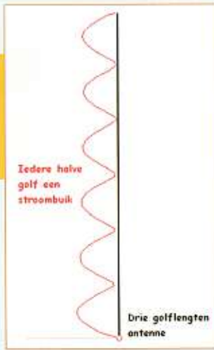
Afb. 3. Stroomverdeling in een straler van drie golflengten lang. Het ziet er uit als zes halve golf stralers op elkaar.
